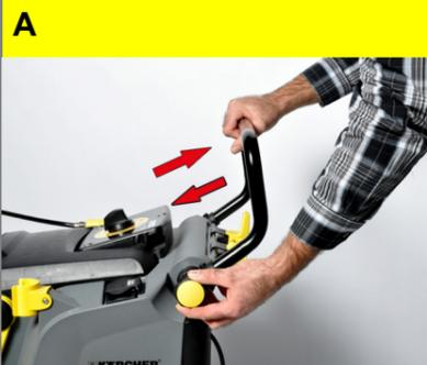
A Dévisser les vis de fixation du guidon de poussée et régler ce dernier.
