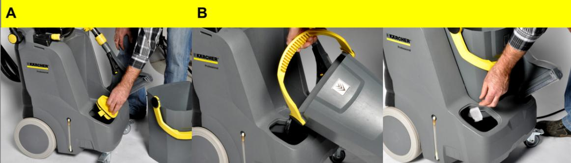
A Ouvrir le couvercle du réservoir d'eau propre.
