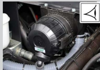
A Contrôler le séparateur centrifuge et filtre d'air, nettoyer le cas échéant.
