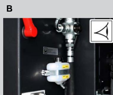
A Contrôler le niveau de l'huile hydraulique.
