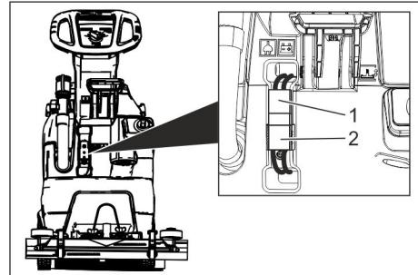
1 Enchufe de la batería, lateral de la batería
