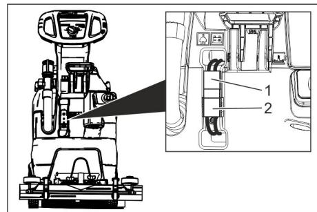
1 Connecteur de la batterie, côté de l'appareil
