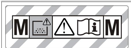
**OPOZORILO:** Ta naprava vsebuje združljivo škodljiv prah. Priznanje in vzdrževanje naprave, vključno z zamenjavo vrečke za prah, smejo opravljati samo strokovne osebe, ki so opremljene z ustrezno zaščitno opremo. Naprave ne vključujte, dokler ni vgrajen celoten filterni sistem in ni bilo preverjeno funkcioniranje volumnskega pretoka.
