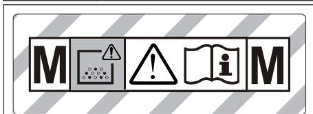
**UPOZORENJE:** Ovaj uređaj sadrži prašine opasne po zdravlje. Pražnjenje i održavanje, uključujući odstranjivanje vrećice s prašinom, smiju izvoditi samo stručne osobe, koje su opremljene prikladnom zaštitnom opremom. Ne uključivati prije nego je instaliran kompletan filterski sistem i prije nego je ispitana funkcija kontrole strujanja.
