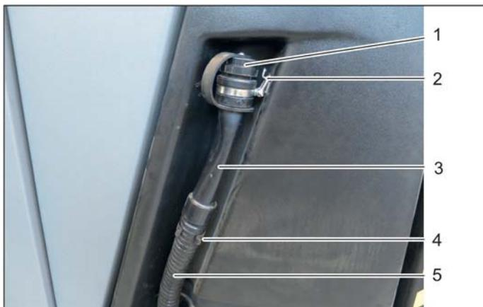
Il flessibile di scarico del serbatoio per acqua pulita si trova sul lato sinistro dell'apparecchio.
