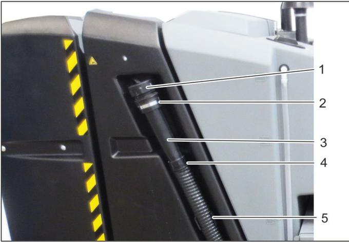
Il flessibile di scarico del serbatoio per acqua sporca si trova sul lato destro dell'apparecchio.
