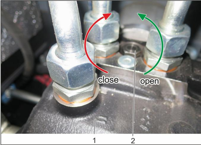
Para deslocar/rebocar o aparelho, deve abrir-se primeiro o funcionamento livre (bypass) da bomba hidráulica.
