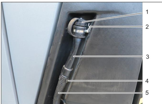
La manguera de desagüe del depósito de agua fresca se encuentra en el lado izquierdo del equipo.
