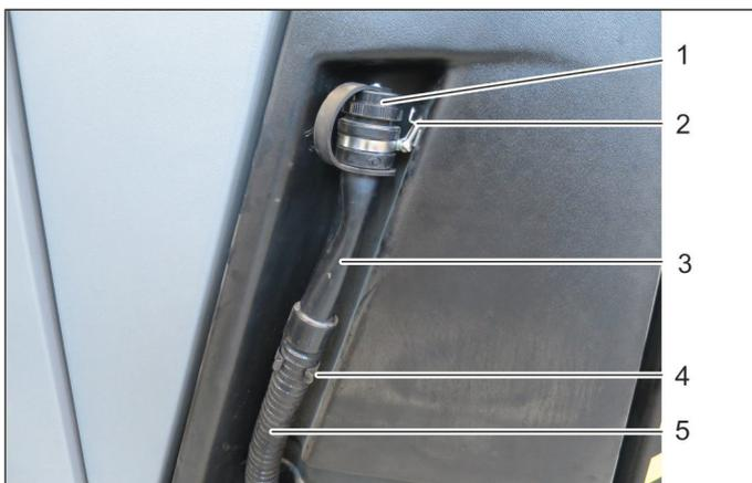
Le flexible d'écoulement du réservoir d'eau propre se trouve sur le côté gauche de l'appareil.
