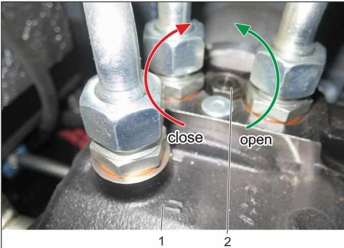
Per spingere / trainare l'apparecchio è necessario prima aprire la corsa libera (bypass) della pompa idraulica.
