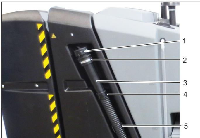
De aftapslang van het vuilwaterreservoir bevindt zich aan de rechterzijde van het apparaat.
