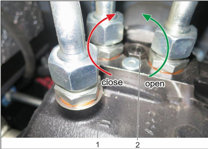
Zum Schieben /Abschleppen des Gerätes muss zuerst der Freilauf (Bypass) der Hydraulikpumpe geöffnet werden.
