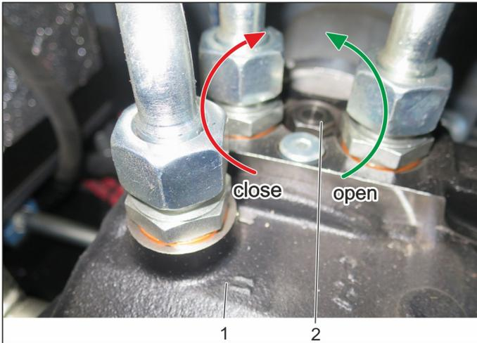
Voor het schuiven/slepen van het apparaat moet eerst de vrijloop (bypass) van de hydraulische pomp worden geopend.
