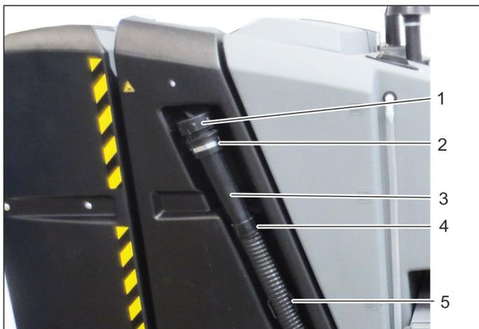
Der Ablassschlauch vom Schmutzwassertank befindet sich auf der rechten Seite des Geräts.
