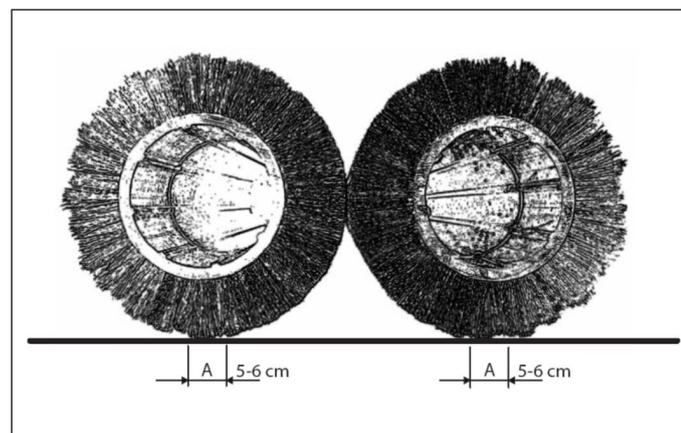
→ La trace de balayage doit être comprise entre 5 et 6 cm. Le réglage de la trace de balayage (pression d'appui au sol de la brosse) s'effectue à l'aide du potentiomètre rotatif sur le tableau de commande.
