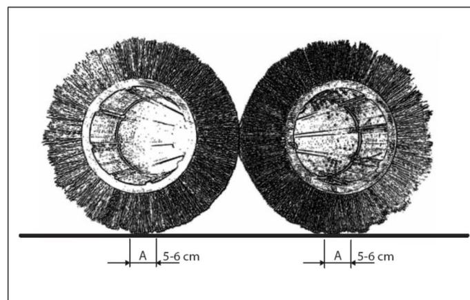
→ Η επιφάνεια σκουπίσματος πρέπει να είναι 5-6 cm. Η ρύθμιση της επιφάνειας σκουπίσματος (πίεση επαφής βουρτσών) γίνεται με το περιστροφικό ποτενσιόμετρο του πεδίου χειρισμού.
