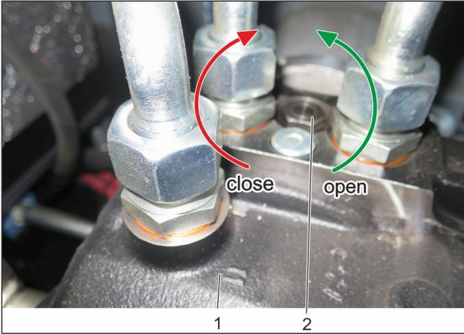
Pour pouvoir pousser/remorquer l'appareil, il faut d'abord ouvrir la roue libre (by-pass) de la pompe hydraulique.
