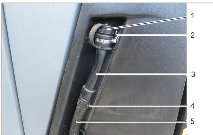
De aftapslang van het verswaterreservoir bevindt zich aan de linkerkant van het apparaat.
