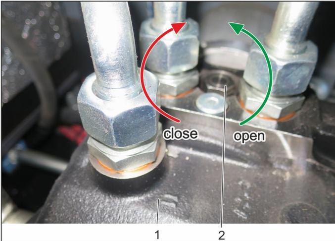
Για την έλξη/ρυθμολόγηση της συσκευής πρέπει να ανοίγεται πρώτα ο ελεύθερος τροχασμός (Bypass) της υδραυλικής αντλίας.
