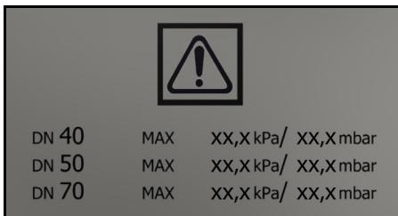
Na nálepke sú uvedené hodnoty pre max. podtlak vo vzťahu k použitému prierezu na nasávacej hadici. Aktuálnu hodnotu môžete odčítať na manometri. Hodnoty platné pre tento prístroj sú uvedené v kapitole *Odčítanie minimálneho objemového prietoku*. Pri nedosiahnutí hodnoty je nutné vyčistiť (pozrite si kapitolu *Vycistenie filtra*) alebo vymeniť filter (pozrite si kapitolu *Výmena filtra*). Rôzne prierezy nasávacej hadice umožňujú prispôsobenie rôznym prierezom prípojok dielov príslušenstva.
