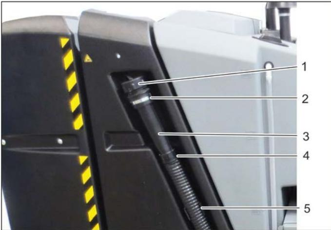
La manguera de desagüe del depósito de agua sucia se encuentra en el lado derecho del equipo.
